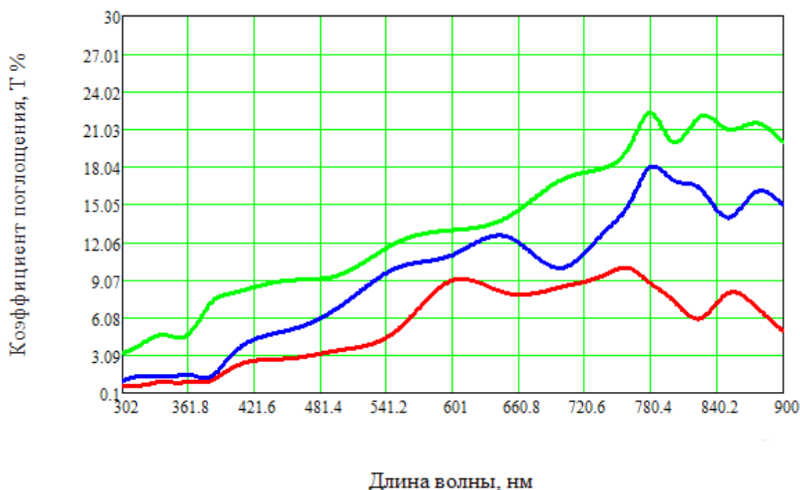
Рис. 2. Зависимость коэффициента поглощения раствора после электрокоагуляции. Снизу вверх: первый — измерения сразу после проведения электрокоагуляции, второй — измерения после 2-х часов отстаивания, третий — после 20 часов отстаивания
