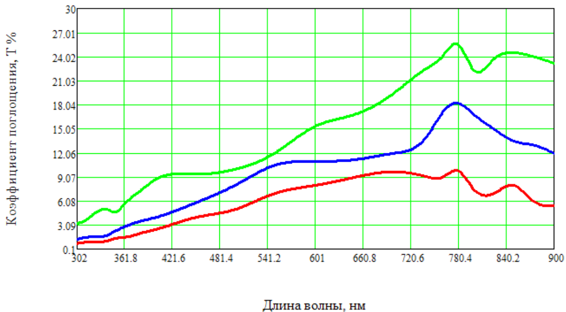
Рис. 3. Зависимость коэффициента поглощения при использовании алюминиевых электродов. Снизу вверх: первый — измерения сразу после электрокоагуляции с использованием алюминиевых электродов, второй — измерения после 2х часов отстаивания, третий — после 20 часов отстаивания
