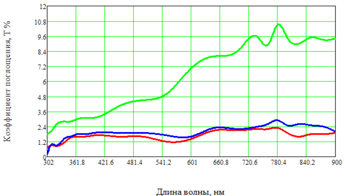
Рис. 1. Зависимость коэффициента поглощения раствора после очистки электрокоагуляцией. Снизу вверх: первый — измерения сразу после проведения электрокоагуляции, второй — измерения после 2х часов отстаивания, третий — после 20 часов отстаивания
