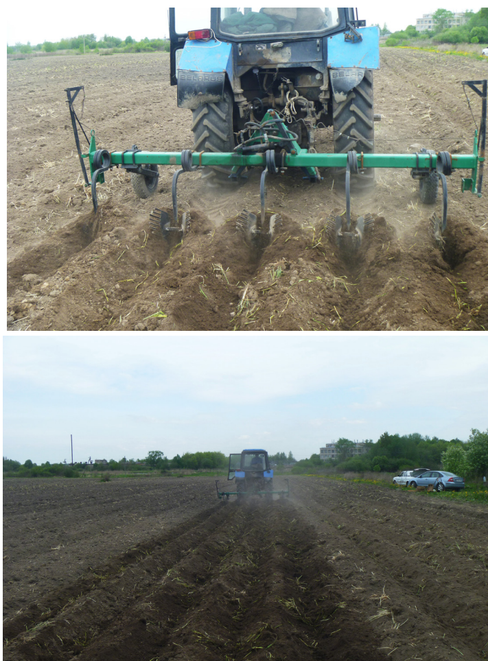
Рис. 3. Нарезка гребней экспериментальным культиватором окучником-глубокорыхлителем с новым рабочим органом
