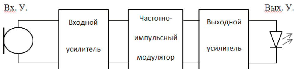
Рис. 1. Упрощённая структурная схема оптического передатчика
