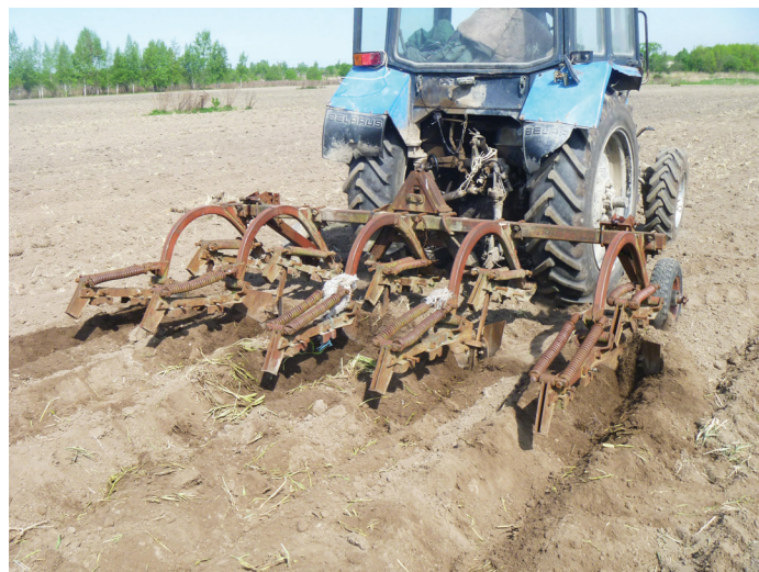
Рис. 2. Нарезка гребней культиватором КНО-2,8
