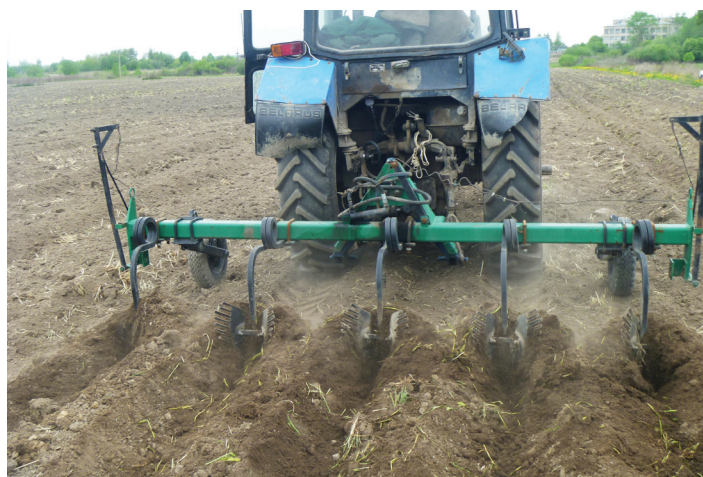
Рис. 3. Нарезка гребней экспериментальным культиватором орудием-глубокорыхлителем КОР-2,8
