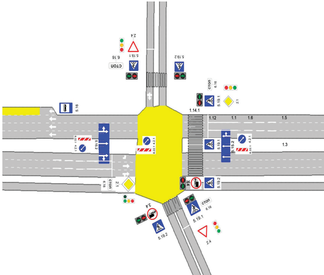
Рис. 2. Дислокация дорожных знаков и разметки на существующем пересечении
