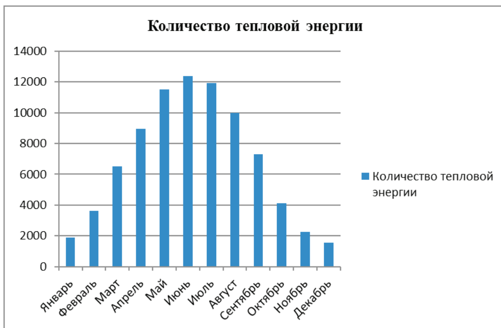
Рис. 1. График годовой выработки тепловой энергии солнечным коллектором
