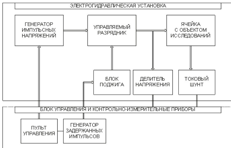
Рис. 1. Блок-схема электрогидроимпульсной установки
