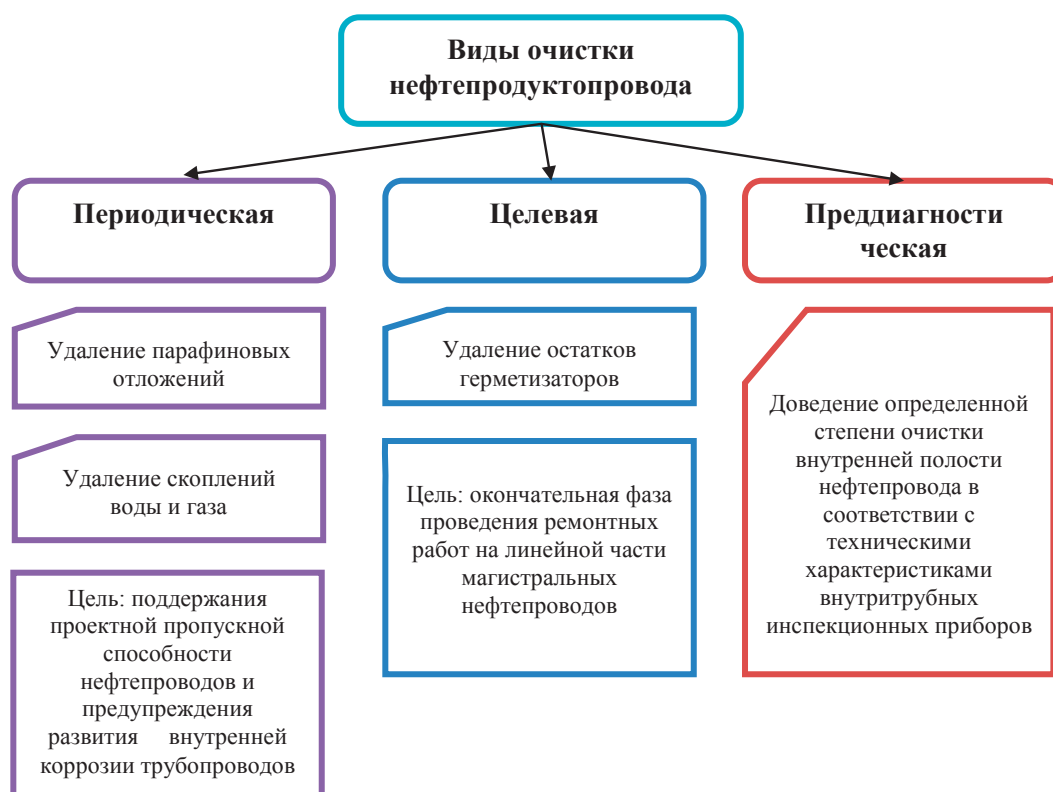
Рис. 1. Классификация видов очистки нефтепродуктопроводов
