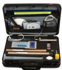
Рис. 1. Лабораторный комплект 2М7 с анализатором качества нефтепродуктов SHATOX SX-300
