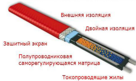
Рис. 2. Конструкция саморегулирующегося кабеля
