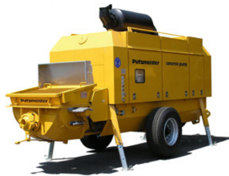
Рис. 1. Стационарный бетононасос Putzmeister BSA 14000 SHP D
