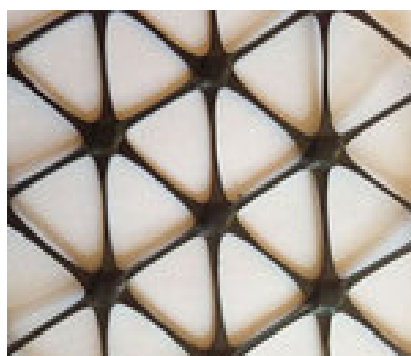
Рис. 3. Внешний вид геосетки Триакс
