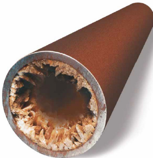
Рис. 1. Солеобразование в эксплуатационной колонне
