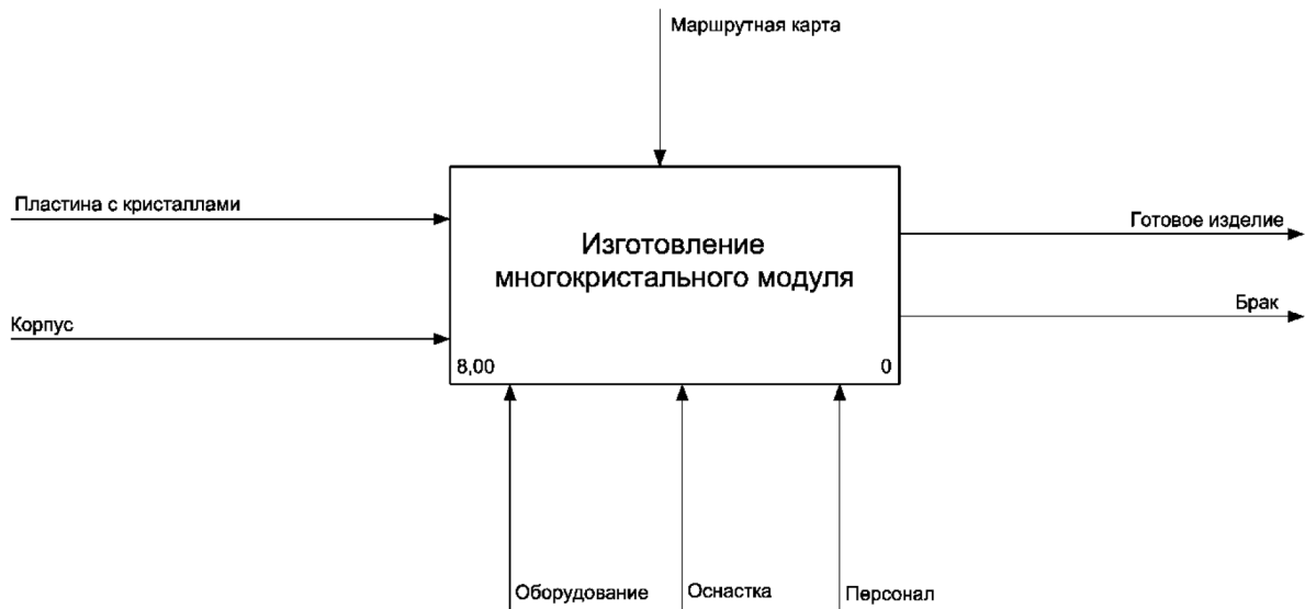
Рис. 2. Контекстная диаграмма ТП изготовления МКМ
