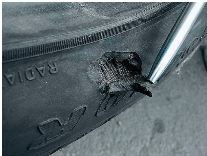
Рис. 4. Вырыв части внешнего слоя шины
