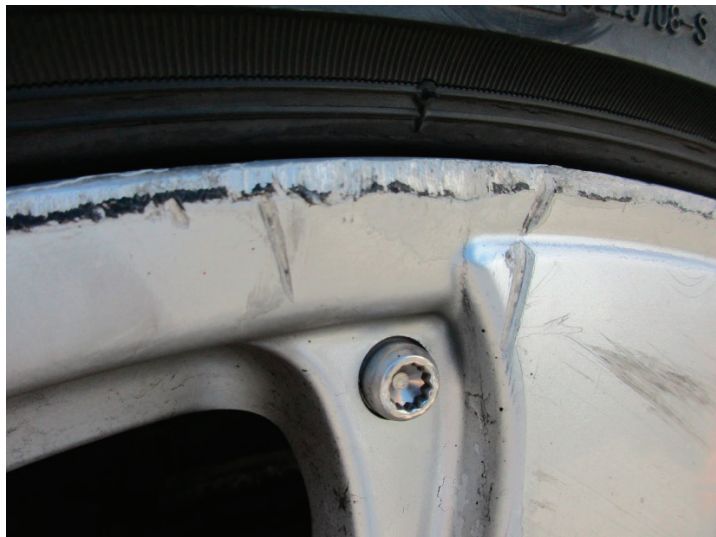
Рис. 2 Внешние повреждения колесного диска
