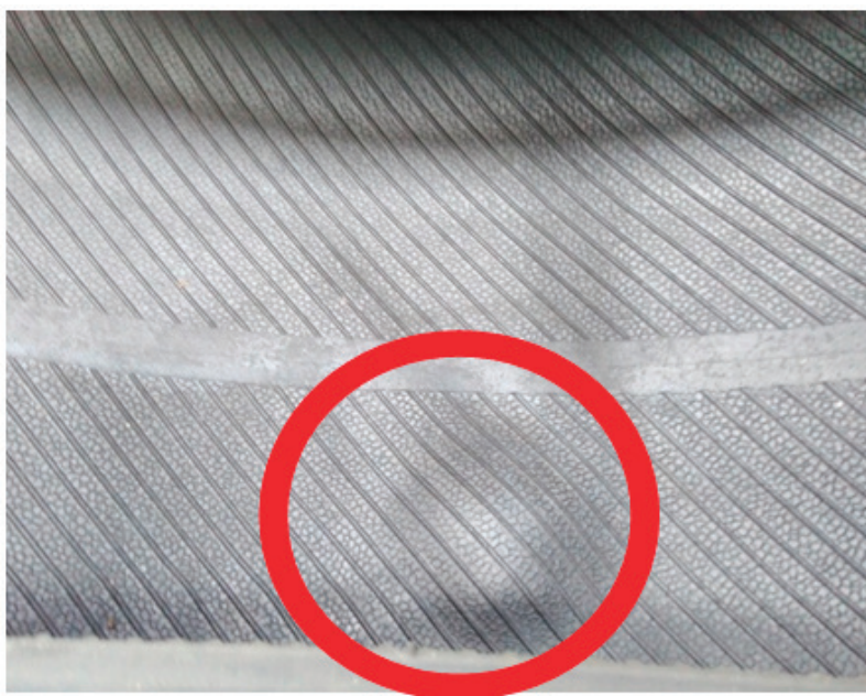
Рис. 5. Повреждение каркаса шины
