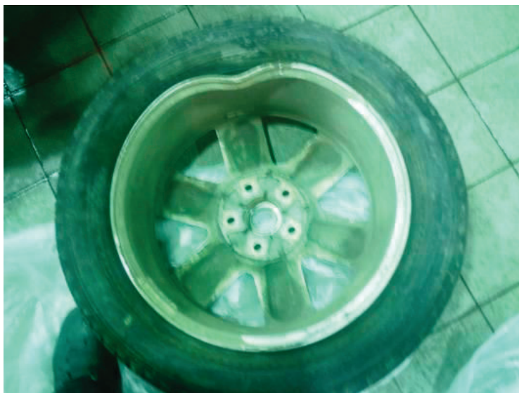
Рис. 3. Изменение формы обода колесного диска
