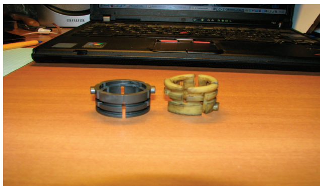
Рис. 7. Сравнение новой и поврежденной втулки рулевой рейки
