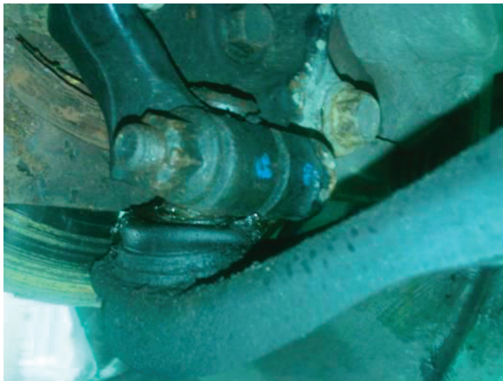
Рис. 6. Деформация поворотного кулака
