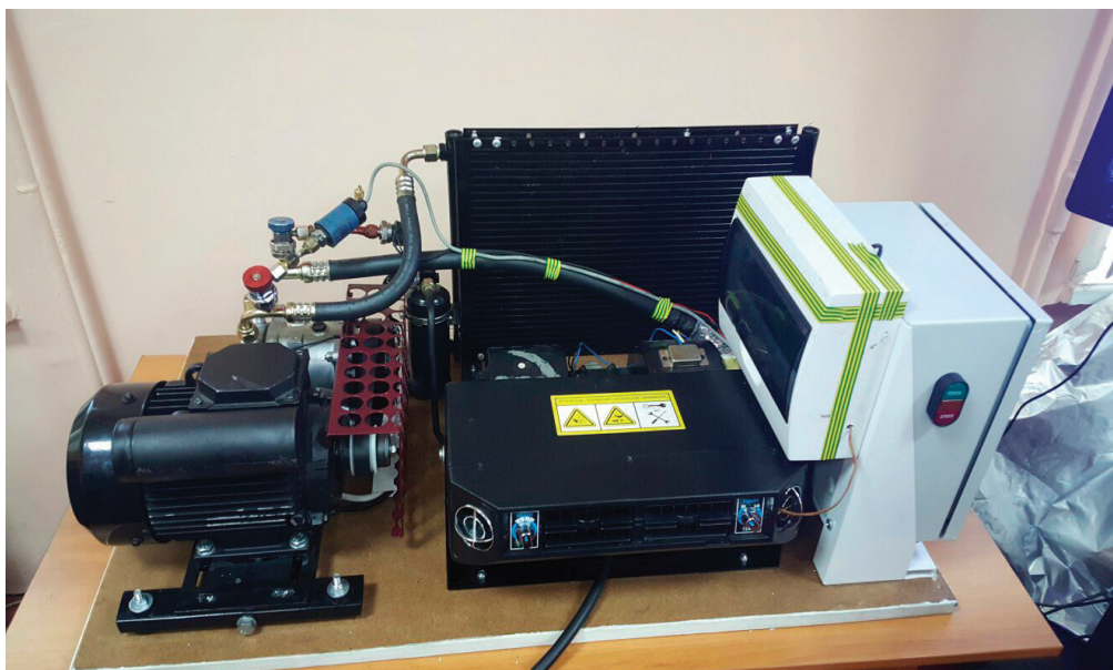
Рис. 1. Основные элементы и принцип работы автомобильного кондиционера
