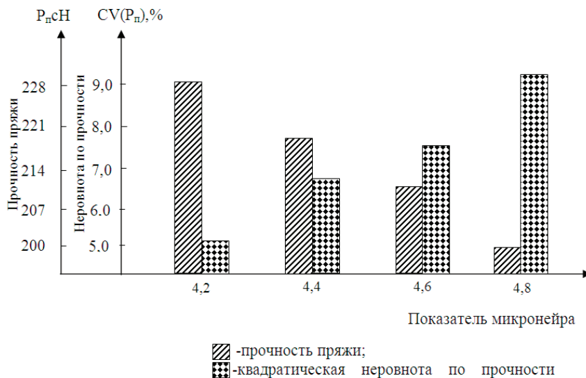
Рис. 3. Влияние показателя микронейра на прочность и квадратическую неровноту по прочности пряжи
