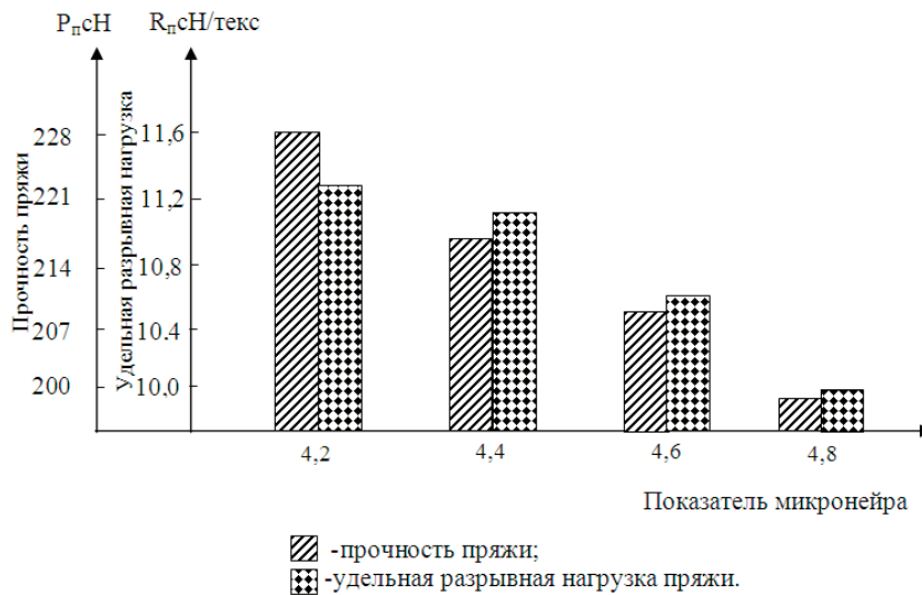
Рис. 2. Влияние показателя микронейра на прочность и удельную разрывную нагрузку пряжи
