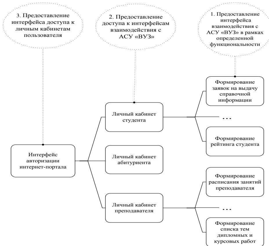
Рис. 3. Функциональная структура порталного решения «Электронный университет»
