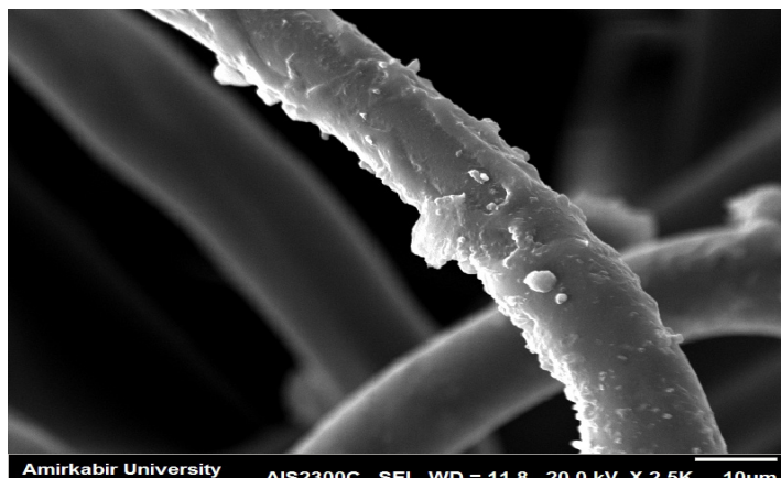
Рис. 1. Микроскопическое электронное изображение слоя нетканого полиэстерного полотна, дополненного графеном
