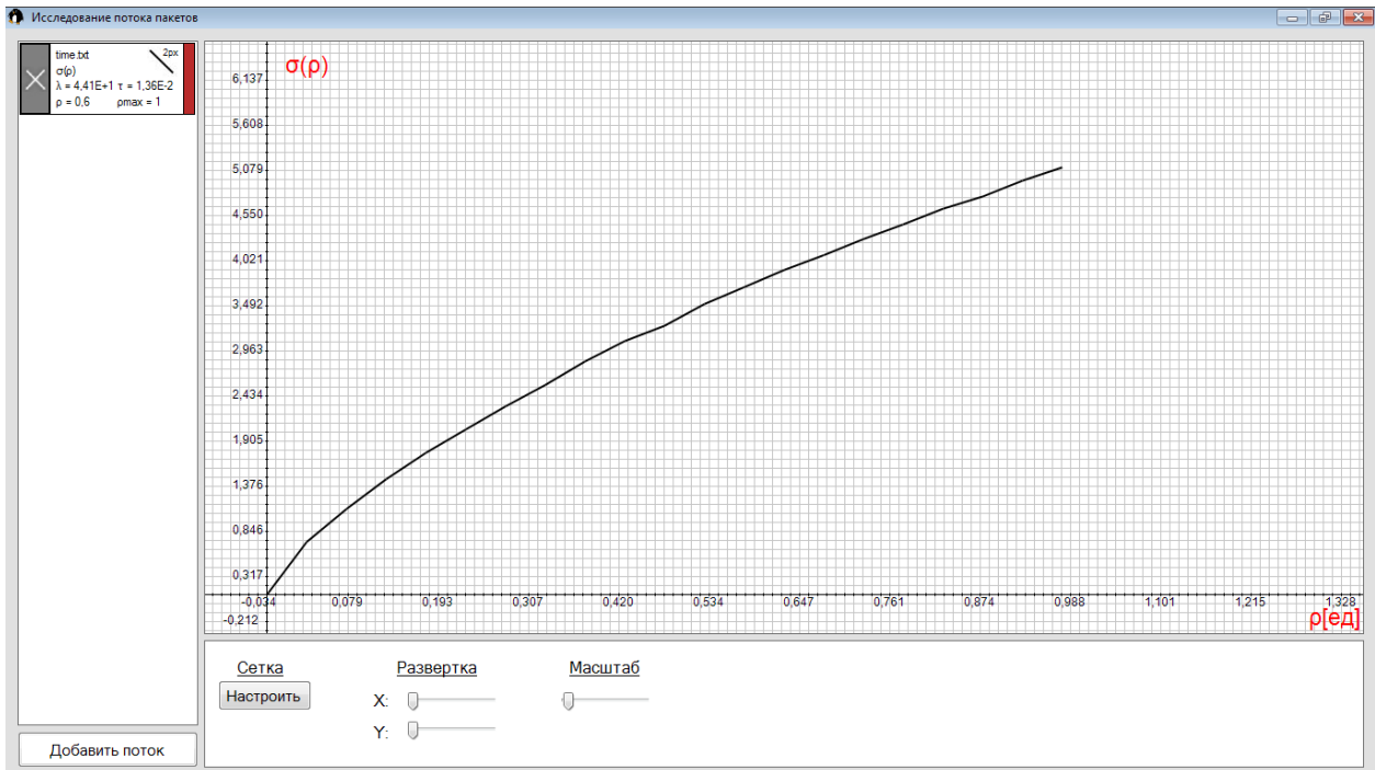
Рис. 5. Зависимость среднеквадратичного отклонения размеров очереди от коэффициента загрузки \rho
