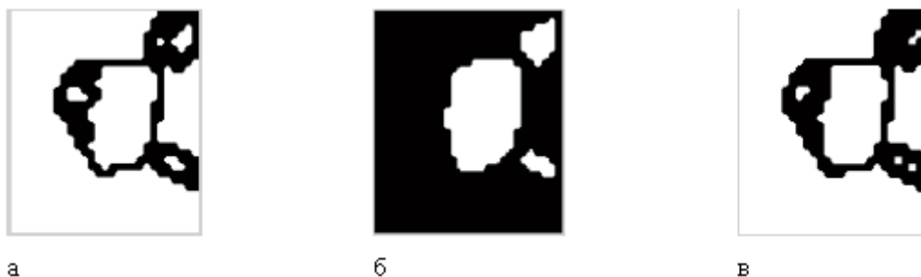
Рис. 3. Бинарные изображения, полученные по трем характеристикам: а) по параметру СКО, б) по среднему значению, в) по параметру гладкости
