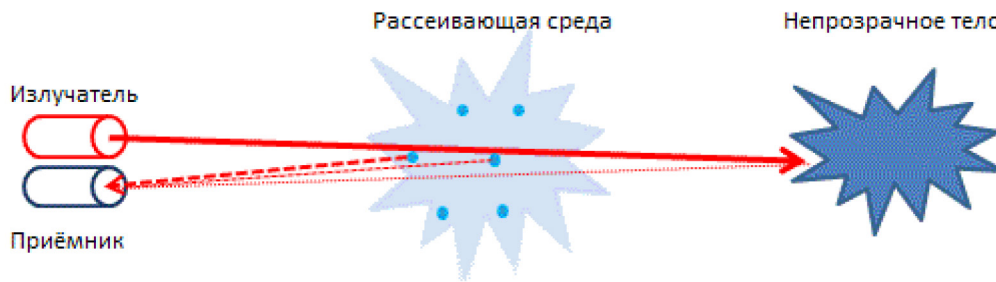
Рис. 1. Принцип действия лидара
