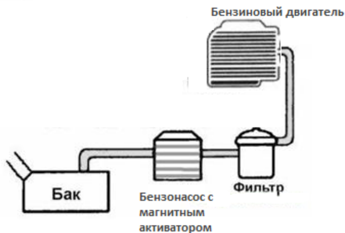
Рис. 4. Схема установки магнитного активатора на ДВС
