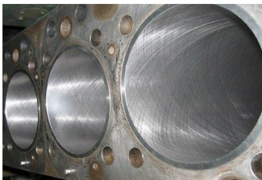
Рис. 2. Цилиндры двигателя внутреннего сгорания после операции хонингования
