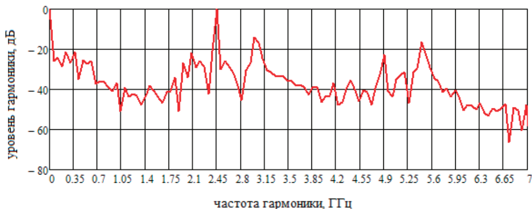
Рис. 1. Спектр выходного сигнала \pi -вида. Колебания основного \pi -вида: норма N_p = 7,0 \times 10^{-15} Ф, добротность Q_p = 90 , f_p = 2,45 ГГц
