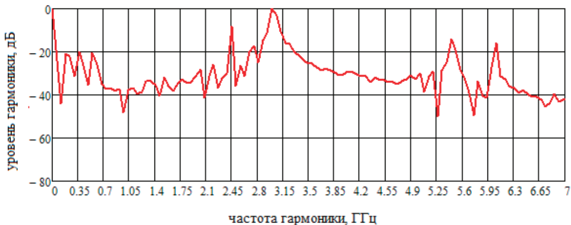
Рис. 2. Спектр выходного сигнала \frac{N}{2}+1 -вида. Колебания основного \frac{N}{2}+1 -вида: норма N_p = 3,0 \times 10^{-16} Ф, добротность Q_p = 11 , f_p = 3,00 ГГц
