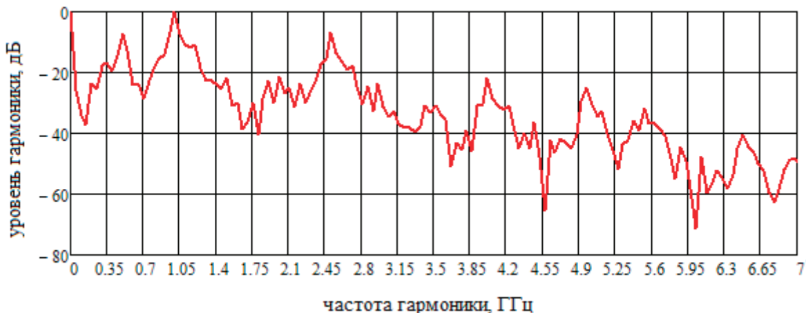
Рис. 3. Спектр выходного сигнала \frac{N}{2}-1 -вида. Колебания основного \frac{N}{2}-1 -вида: норма N_p = 3,0 \times 10^{-16} Ф, добротность Q_p = 5 , f_p = 2,01 ГГц
