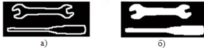
Рис. 6. Результат применения морфологической операции эрозии и дилатации (а) и операции заполнения областей внутри контура (б)
