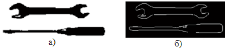
Рис. 5. Результат применения сегментации на основе пороговой обработки (а) и контурной сегментации методом Канни (б)
