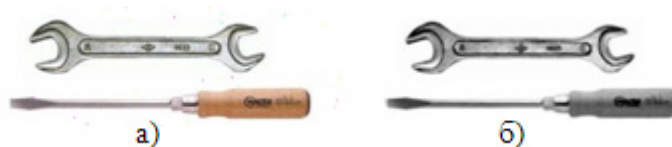
Рис. 3. Исходное цветное изображение (а) и результат применения медианной фильтрации к обрабатываемому изображению в СТЗ робота для рекламного стенда кафедры (б)
