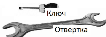
Рис. 11. Пример ошибочного распознавания изображений в СТЗ робота для рекламного стенда кафедры
