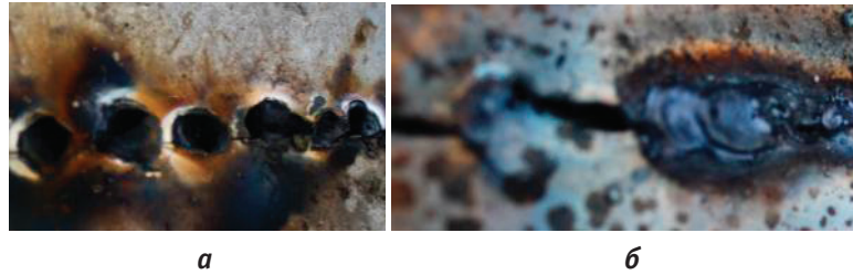
Рис. 1. Прожиг (а) и непровар (б) при дуговой стыковой сварке
