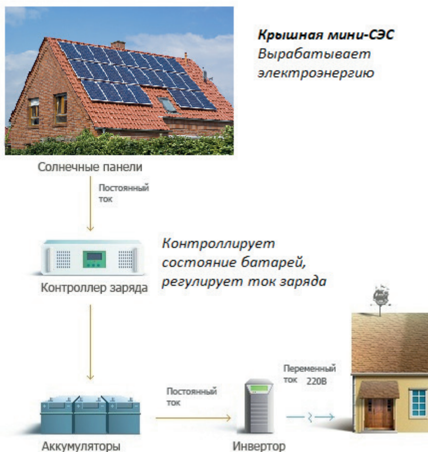
Рис. 1. структура малой СЭС
