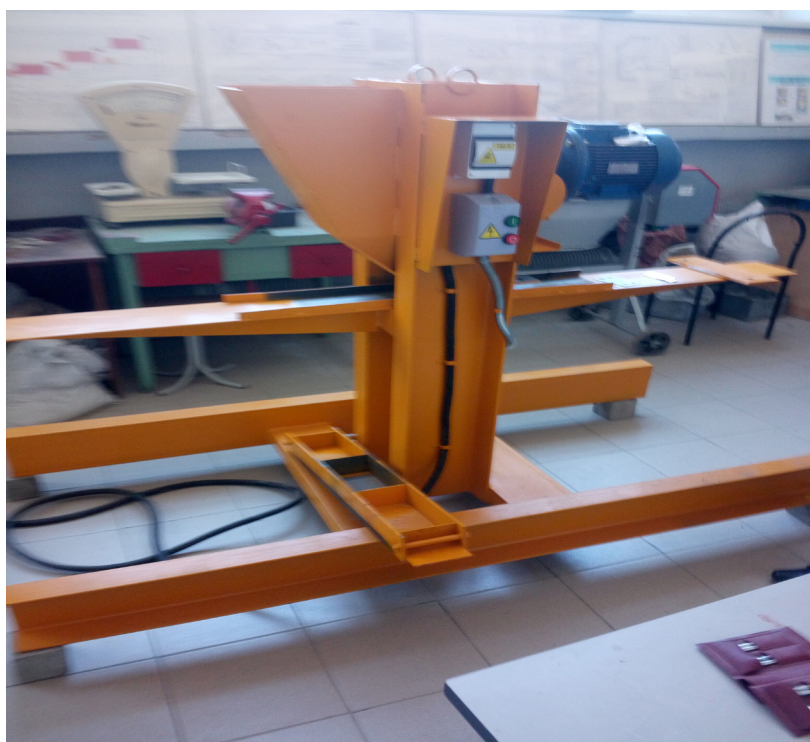
Рис. 3. Вид общий формовочной установки с ударно-вибрационным механизмом уплотнения
