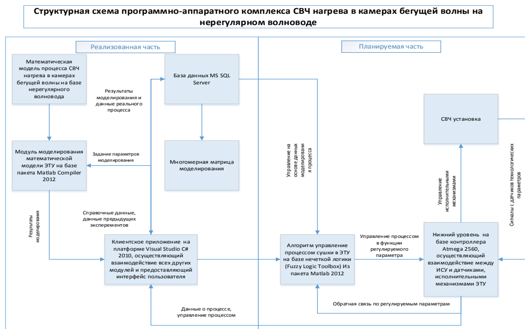
Рис. 2. Структурная схема программно-аппаратного комплекса СВЧ нагрева в камерах бегущей волны на нерегулярном волноводе
