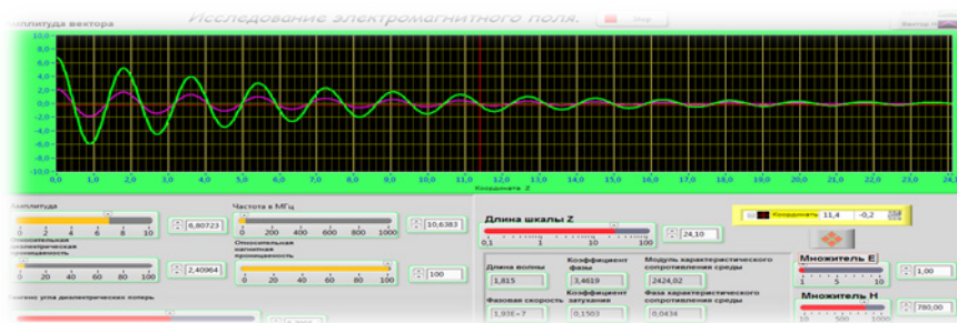
Рис. 2. Процесс визуального отображения плоской электромагнитной волны по измененным параметрам
