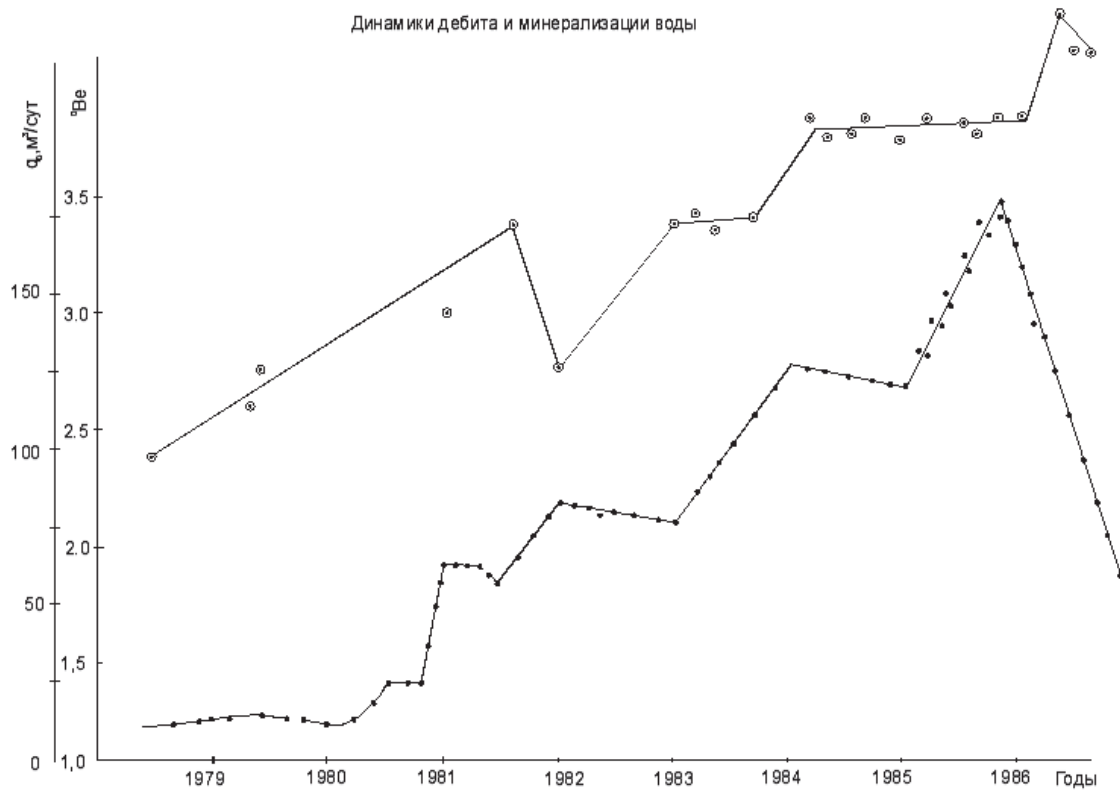
Рис. 4. Изменение дебита воды во времени и ее минерализации в продукции скв. 40, эксплуатирующей VIII гор.
