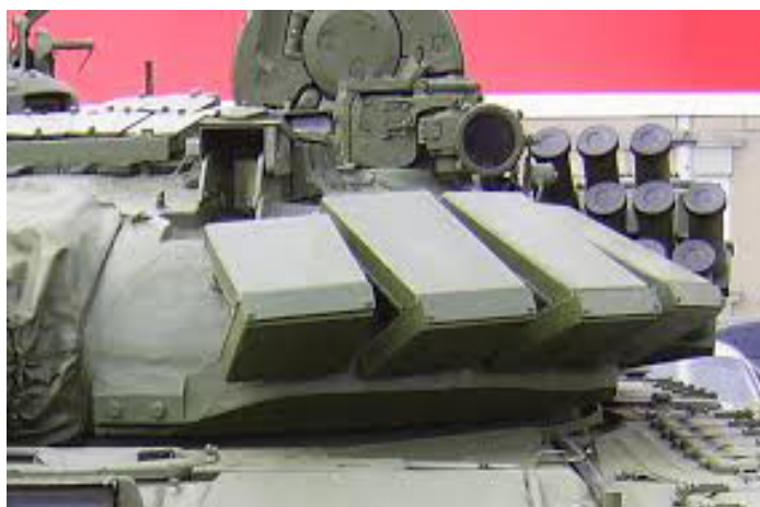
Рис. 1. Пример установки элементов 4С22 динамической защиты «Контакт-5» на башне танка
