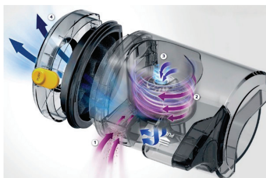
Рис. 2. Схема всасывания воздуха: 1 — циклонная камера; 2 — спираль; 3 — центральная часть камеры; 4 — выход воздуха
