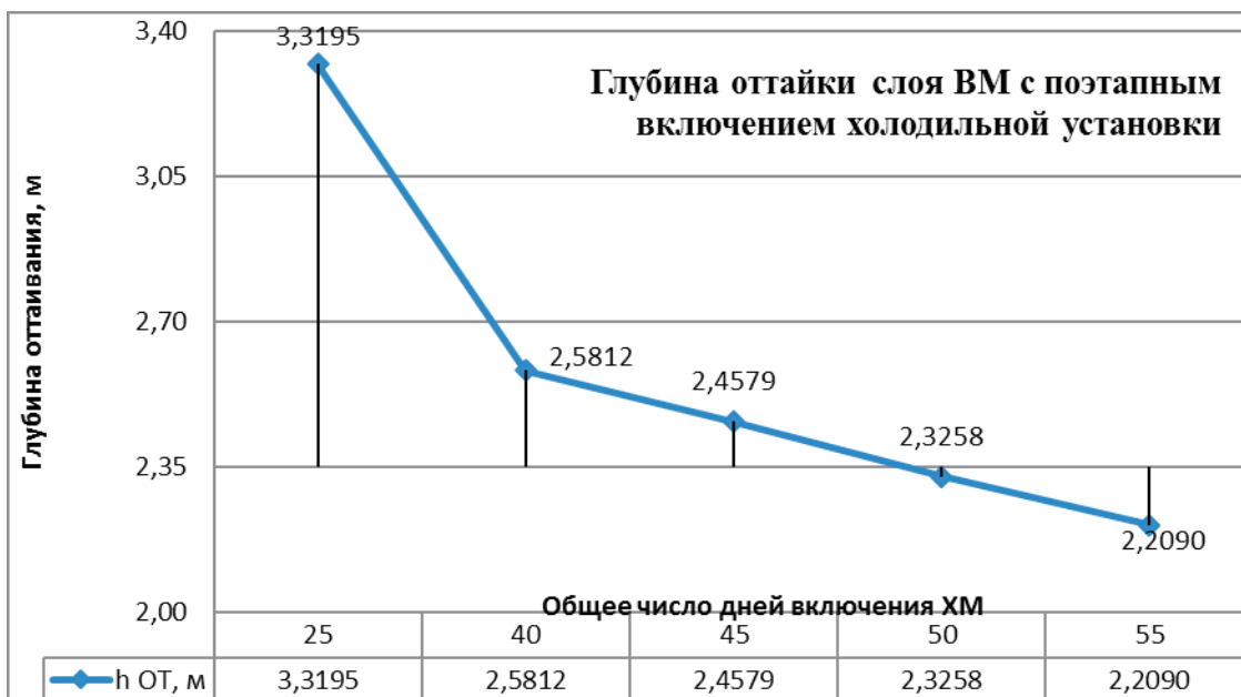
Рис. 3. Глубина оттаивания грунта (начало сентября) с использованием СОУ холодильной установки при поэтапном включении
