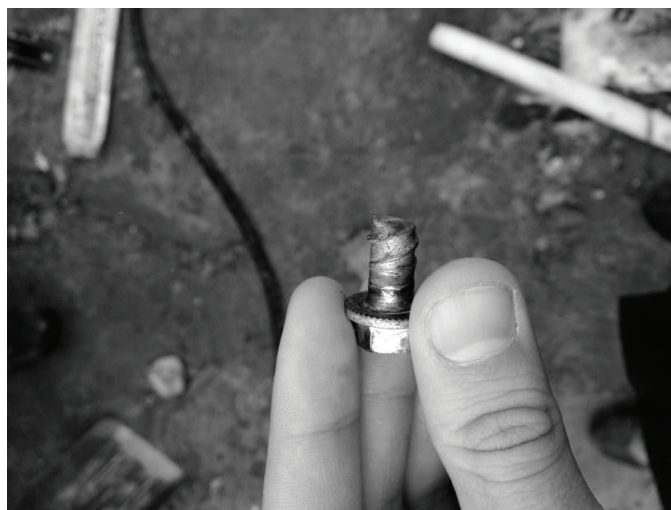
Рис. 1. Болт, попавший в арматуру
