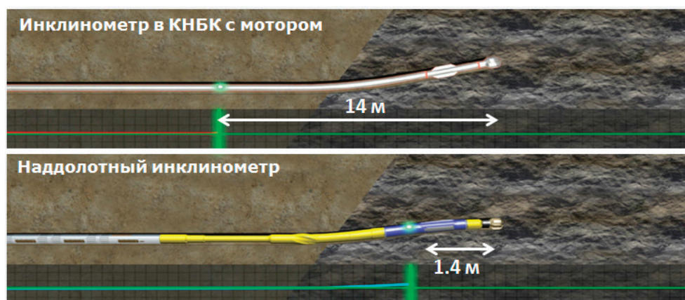
Рис. 4. Графическое представление расстояния от долота до инклинометра.
