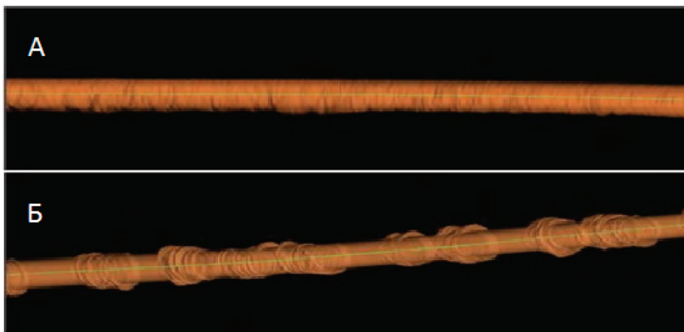
Рис 3. Сравнение профилей стволов после применения РУС (а) и ВЗД (б)
