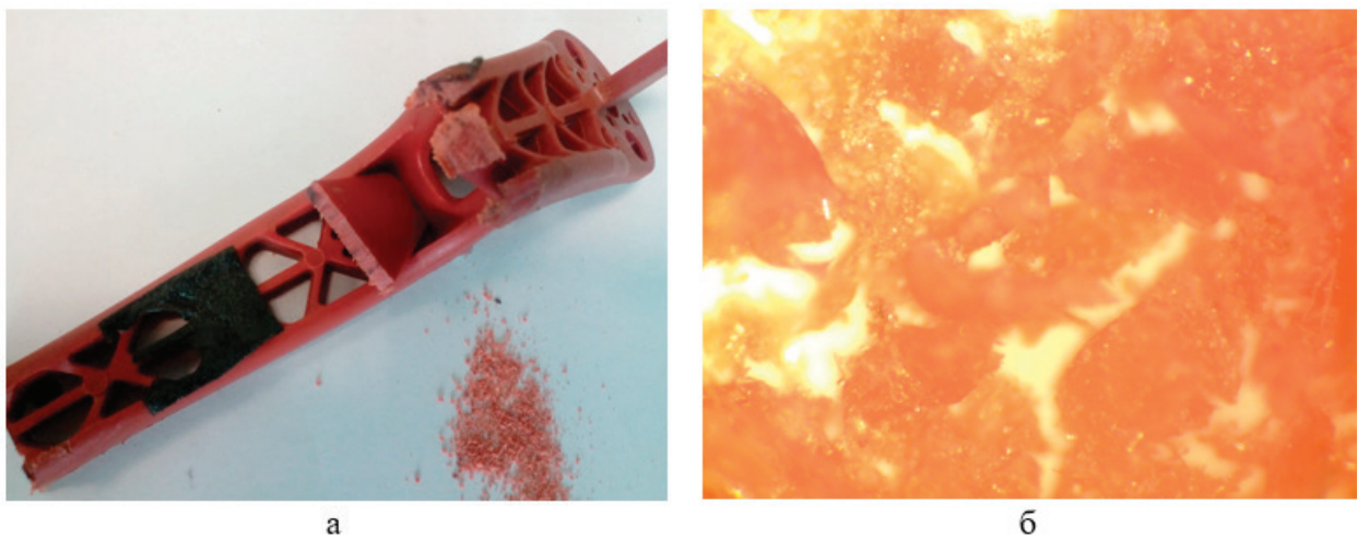
Рис. 3. Спил луча (а), микроскопическое исследование (б).
