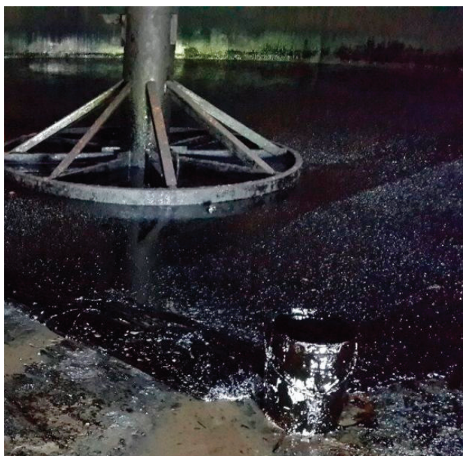
Рис. 1. Донные отложения в резервуаре для товарной нефти
