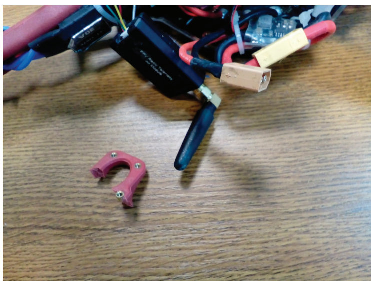
Рис. 2 Разрушение луча рамы вследствие столкновения квадрокоптера с преградой
