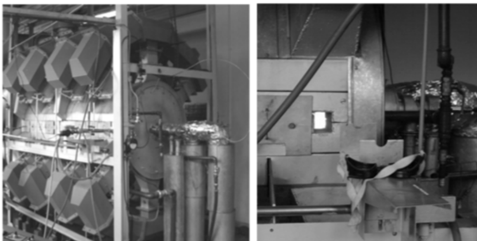
Рис. 2. Вид лабораторной установки с местом расположения камеры перпендикулярно к оси горелки
