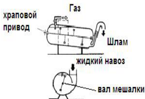
Рис. 3. Горизонтальный реактор с простейшим перемешивающим устройством
