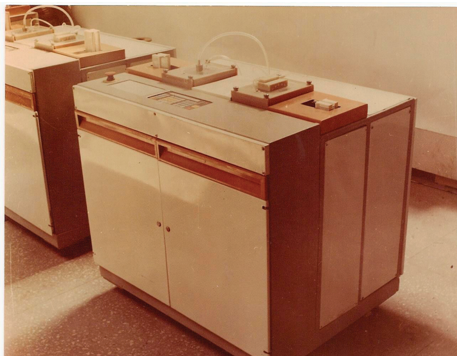
Рис. 4. Гибкие автоматизированные модули фотолитографии, состоящие из унифицированных операционных структур, способных менять свою функциональную принадлежность и специализацию в зависимости от степени ассоциаций с программными и аналитически-контрольными блоками
