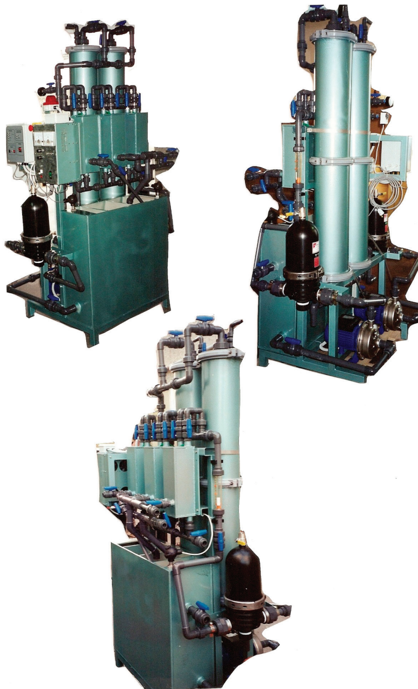
Рис. 7. Оборудование для обработки сточных вод, выполненное по структуре гибкого производственного технологического модуля
