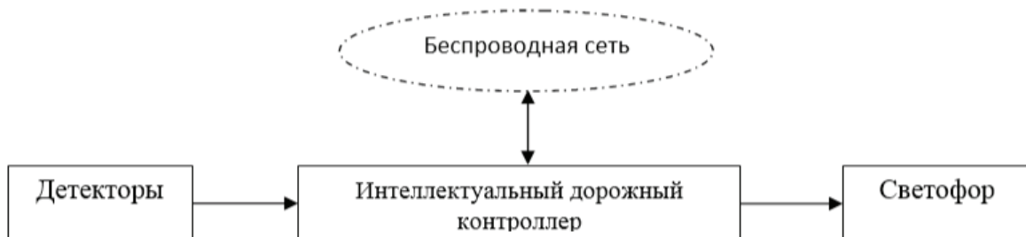
Рис. 2. Структура АСУДД третьего поколения
