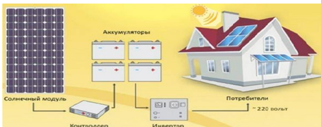
Рис. 1. Схема снабжения солнечной энергией
