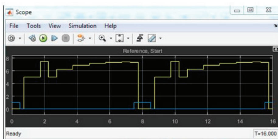
Рис. 7. Пример осциллограммы с выхода формирователя опорного напряжения (Reference на рис. 1), соответствующей двум циклам преобразования, а также импульса Start.
