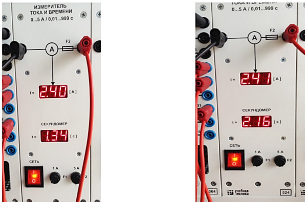
Рис. 4. Показания измерителя тока и времени: а) при кратковременном КЗ; б) при устойчивом КЗ
