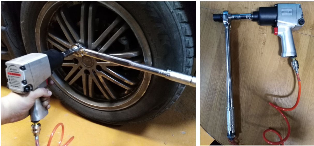
Рис. 1. Конструкция гайковёрта со встроенным динамометрическим ключом
