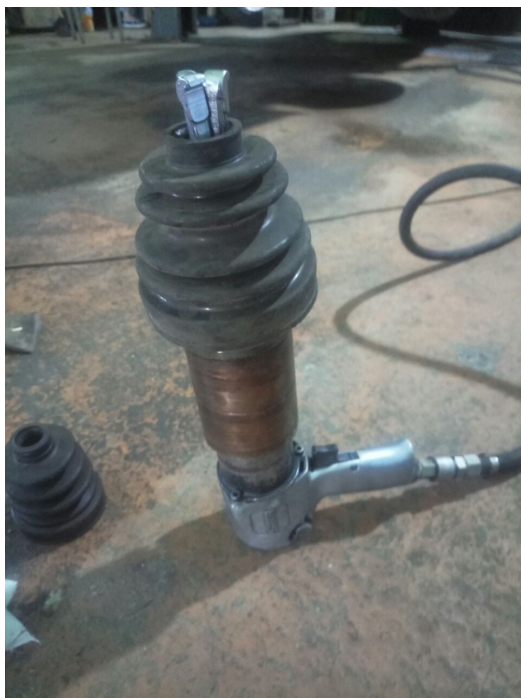
Рис. Устройство для установки пыльников на шарниры приводных валов равноускоренных угловых скоростей автомобилей
