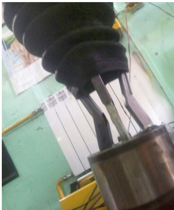
Рис. Устройство для установки пыльников на шарниры приводных валов равноускоренных угловых скоростей автомобилей
