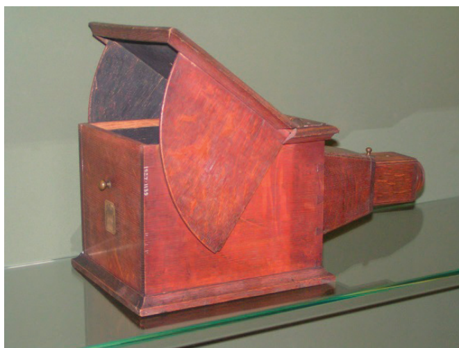
Рис. 1. Общий вид камеры-обскуры
