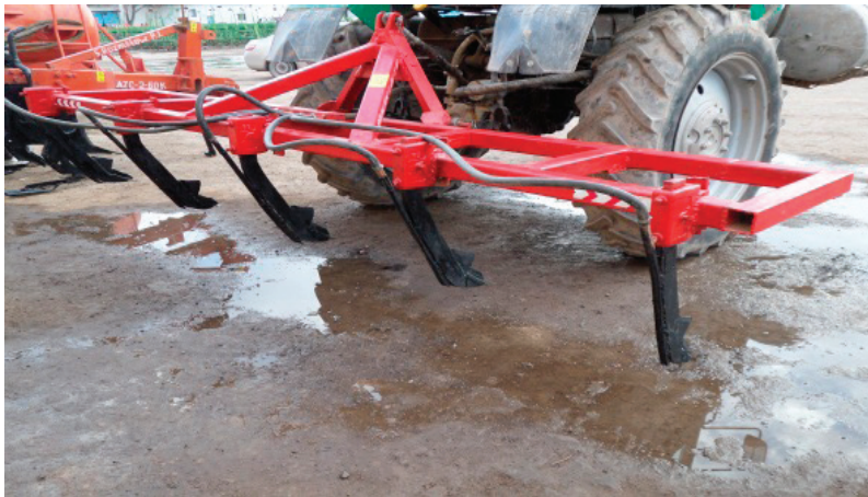
Рис. 1. Устройство для внесения жидких минеральных удобрений (КР-5–40)
