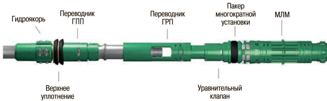
Рис. 1. Компоновка с двойным пакером (МЛМ — магнитный локатор муфт)
