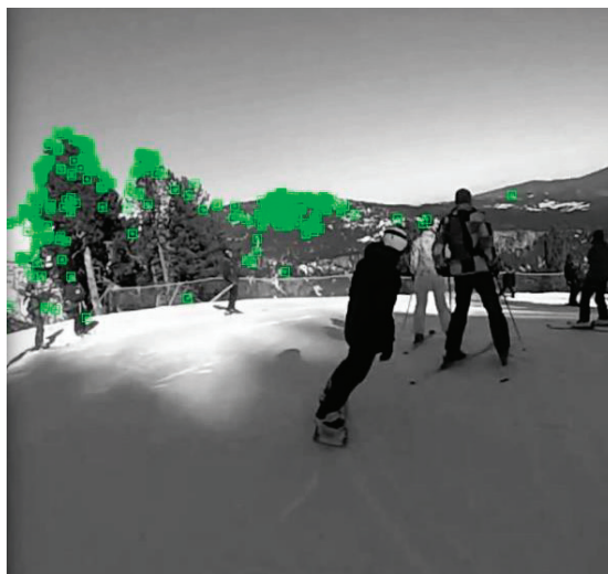
Рис. 4. Определение опорных точек изображения в алгоритмах ORB SLAM
