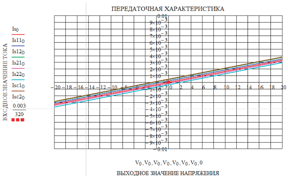
Рис. 2. Калибровочная характеристика датчика напряжения
