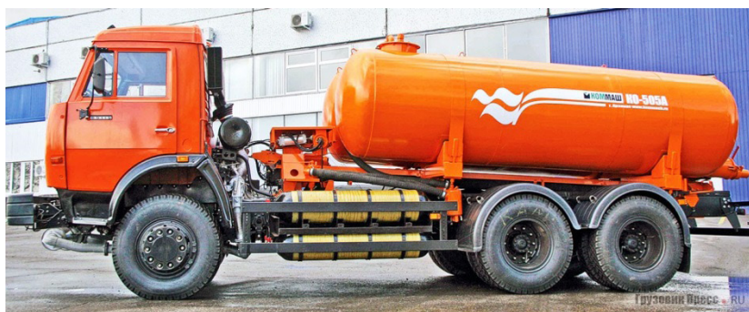
Рис. 1. Вакуумная машина К0-505А на метане производства арзамасского ОАО «КОММАШ»
