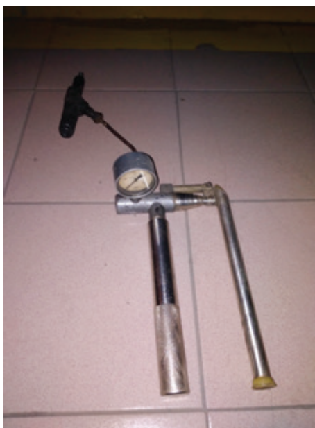
Рис. 2. Устройство KI-16301A с присоединённой форсункой
