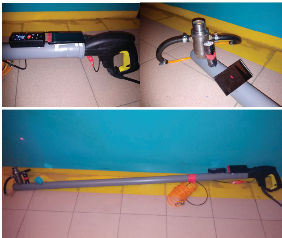
Рис. 5. Опытный образец предлагаемой конструкции угловой насадки для мойки днища с визуальным и дистанционным контролем
