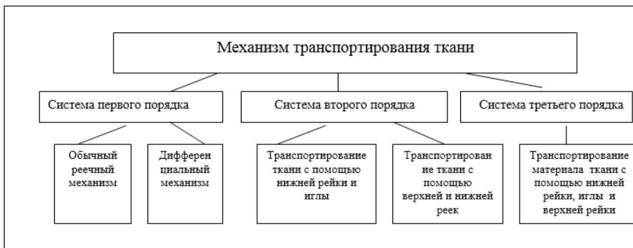
Рис. 1. Виды механизмов транспортирования ткани
