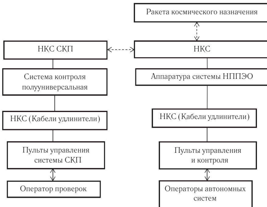
Рис. 1. Схема структуры наземного проверочно-пускового электрооборудования ракеты космического назначения «Союз ФГ»
