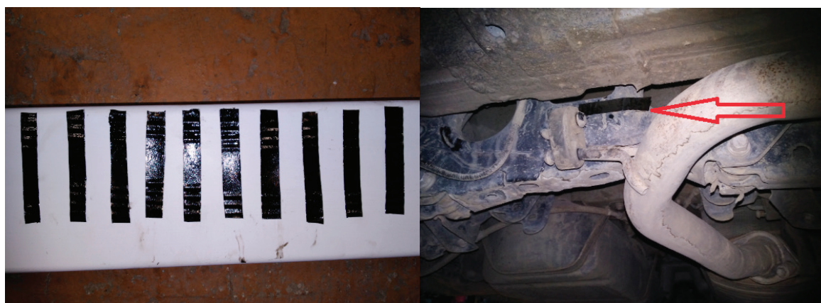
Рис. 2. Пластины с сильносвязанными загрязнениями и пример их установки под днищем автомобиля
