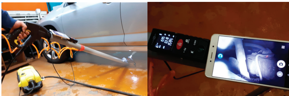
Рис. 1. Экспериментальная угловая насадка с визуальным и дистанционным контролем
