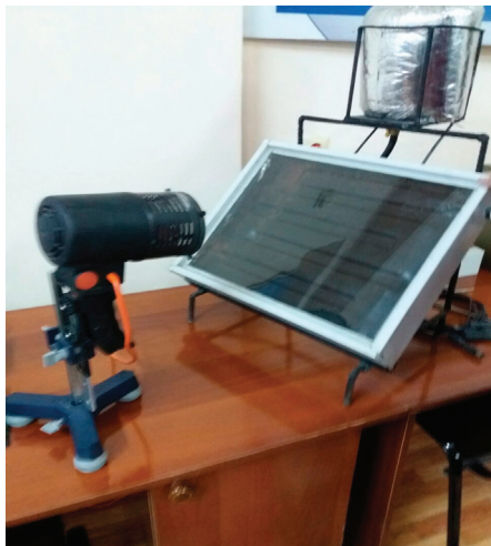
Рис. 1. Экспериментальная установка системы горячего водоснабжения с использованием плоского солнечного коллектора
