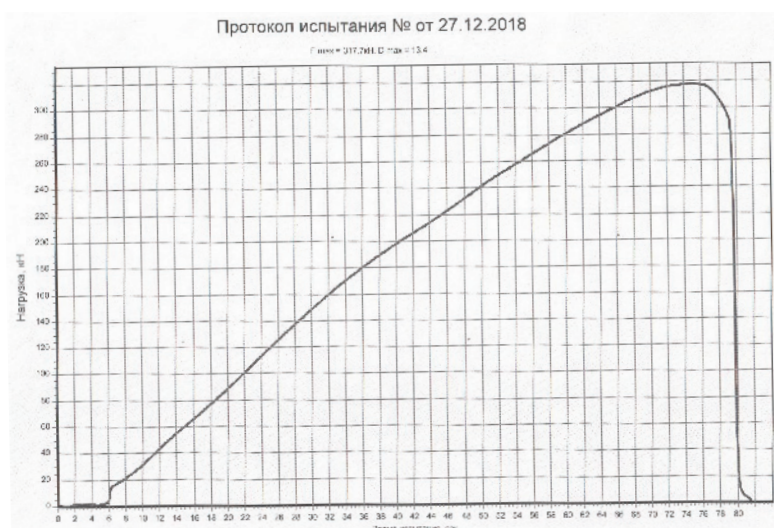
Рис. 2. Предел прочности при сжатии куба с пластификатором 1% (состав № 2)
