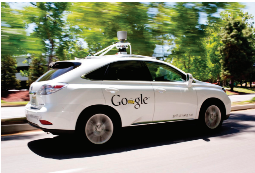
Рис. 2 Беспилотный автомобиль компании Google на основе стандартного LexusRX
