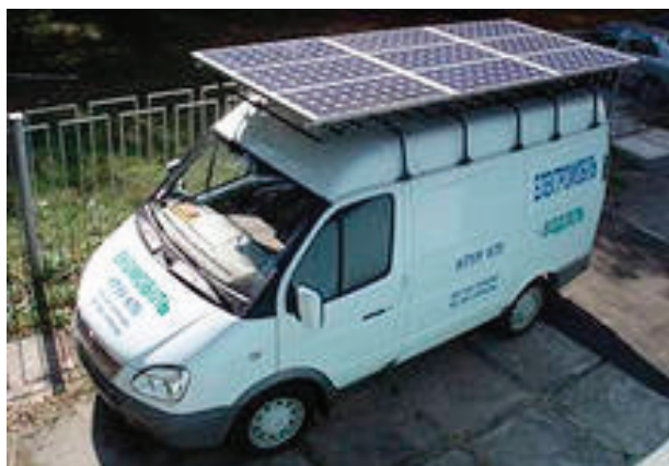
Рис. 4 Энергетически независимый электромобиль с солнечной батареей
