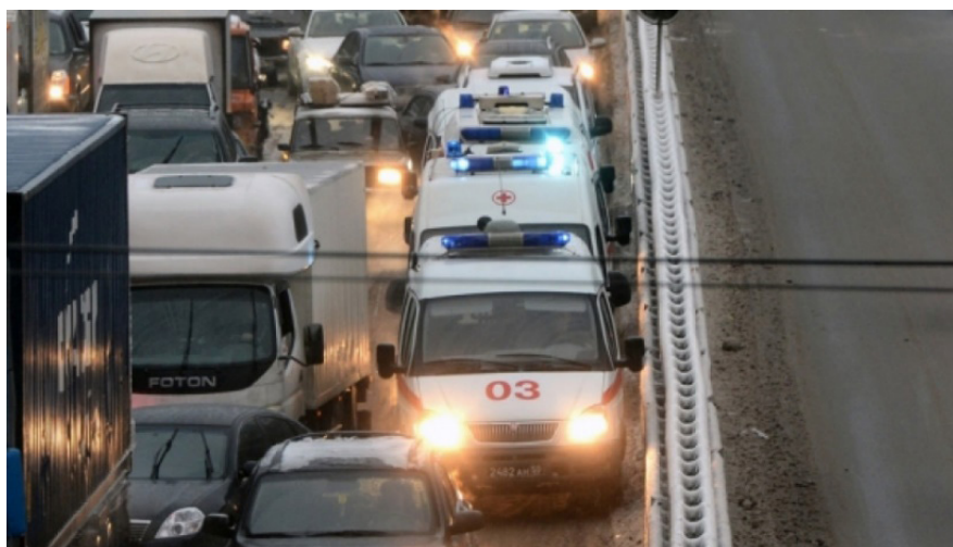
Рис. 1. Двустороннее дорожное ограждение барьерного типа препятствует свободному перемещению кареты скорой помощи
