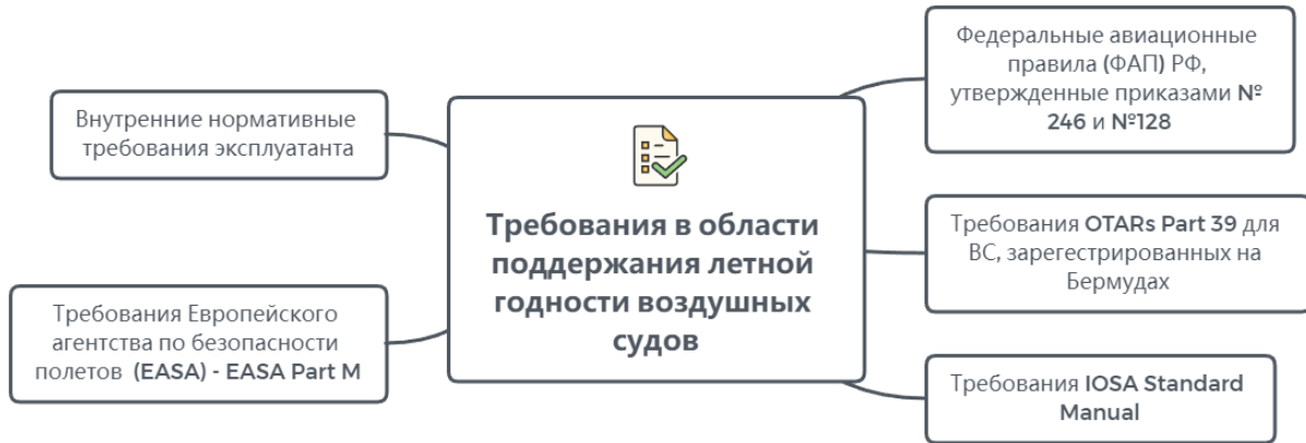
Рис. 1. Требования по поддержанию летной годности, применимые для авиакомпании РФ, эксплуатирующей воздушные суда, зарегистрированные на Бермудах, занесенной в реестр эксплуатантов IOSA
