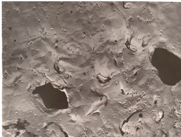
Рис. 2. РЭМ-картина поверхности Pd-Va, снятая после эксплуатации в течение более 500 ч
