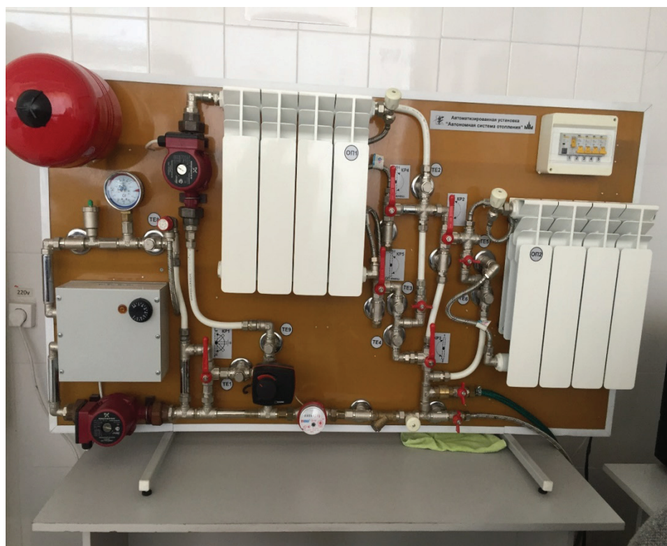
Рис. 3. Экспериментальная установка «Автоматизированная система отопления»
