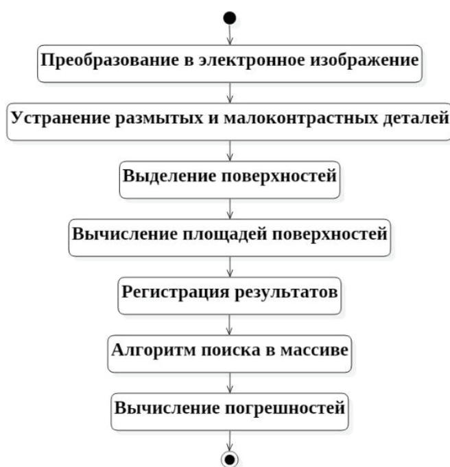
Рис. 1. Алгоритм функционирования оптической системы распознавания
