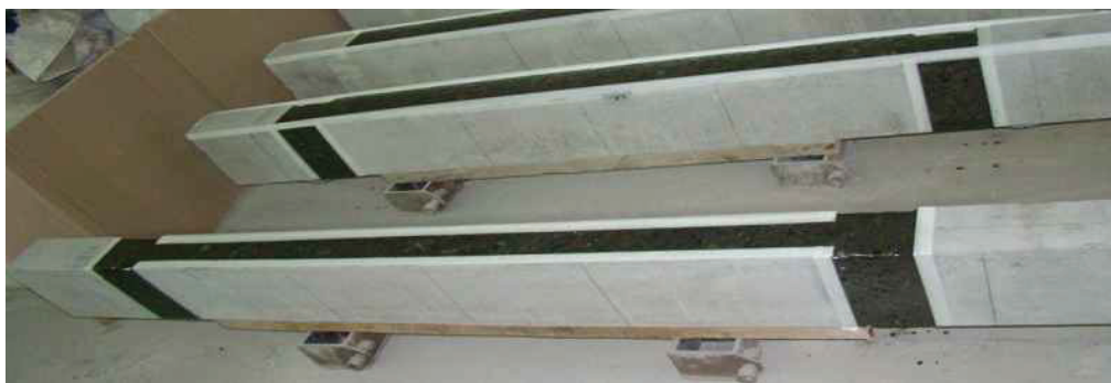
Рис. 2. Усиление деревянной балки углеволокном
