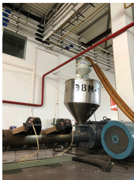
Рис. 6. Экструзионно-раздувная машина с установленной на ней сушильным бункером и вакуумным загрузчиком
