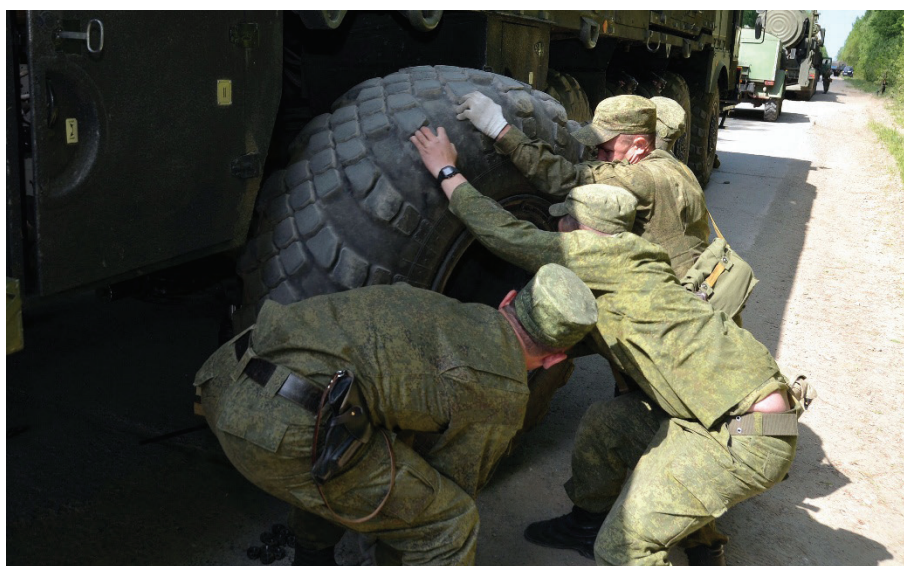
Рис. 4. Выполнение работ по замене пробитого колеса
